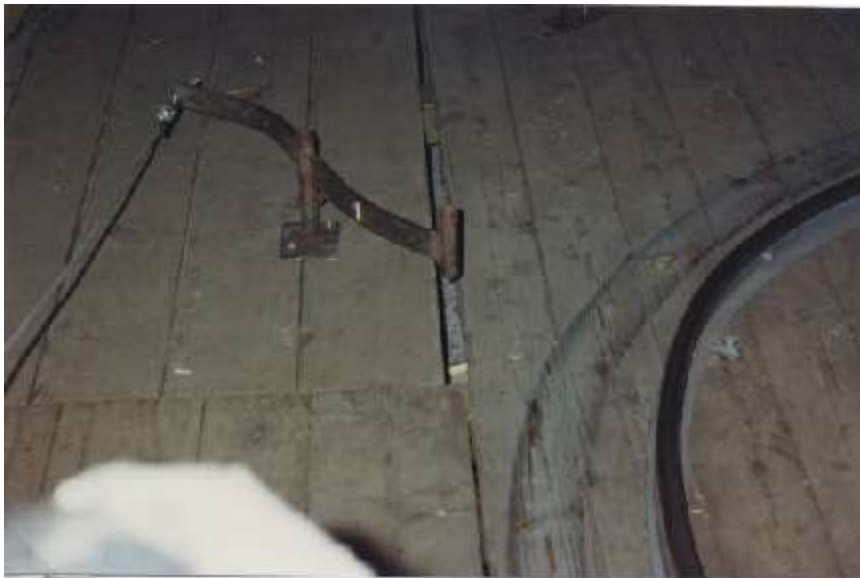
Auslösung einer Erscheinung durch den vorbeifahrenden Wagen mittels mechanischer Hebel (Wiener Prater-Geisterbahn zu Basel).
